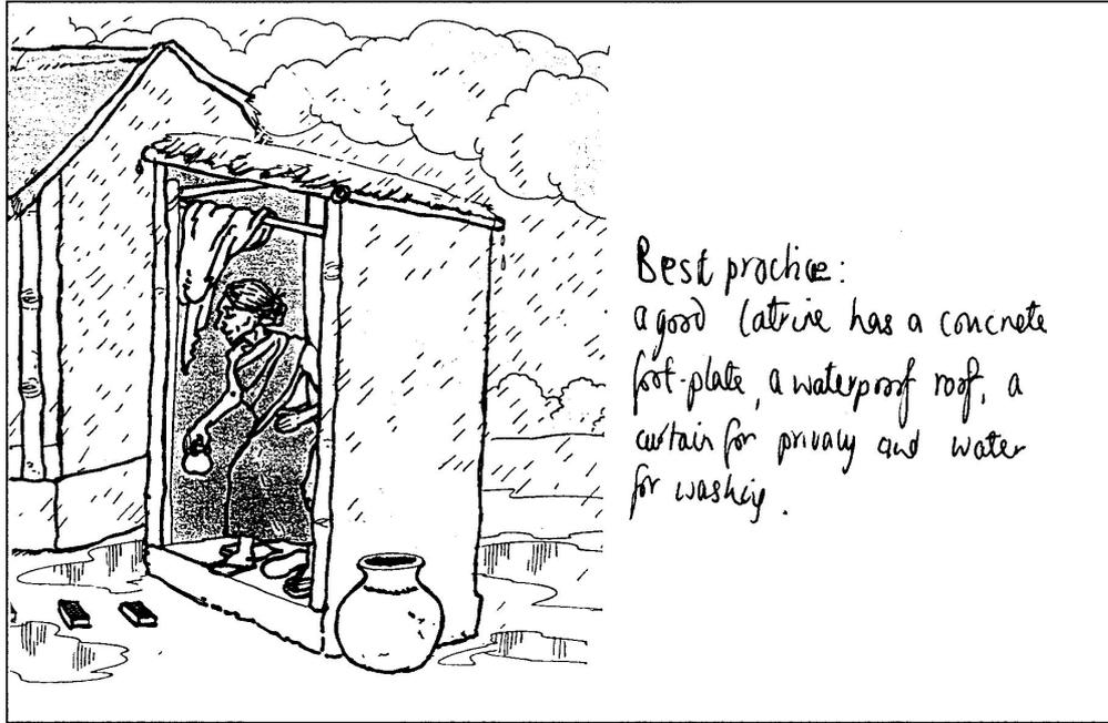
最佳实践：一个像样的厕所需要两块水泥砖垫脚，房顶不漏雨，门帘遮着蔽体，还要有水洗手冲厕所。
